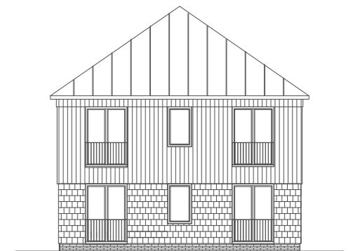
дерево + керамические блоки (вальмовая кровля)
