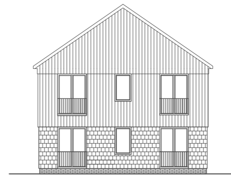
дерево + керамические блоки (двускатная кровля)
